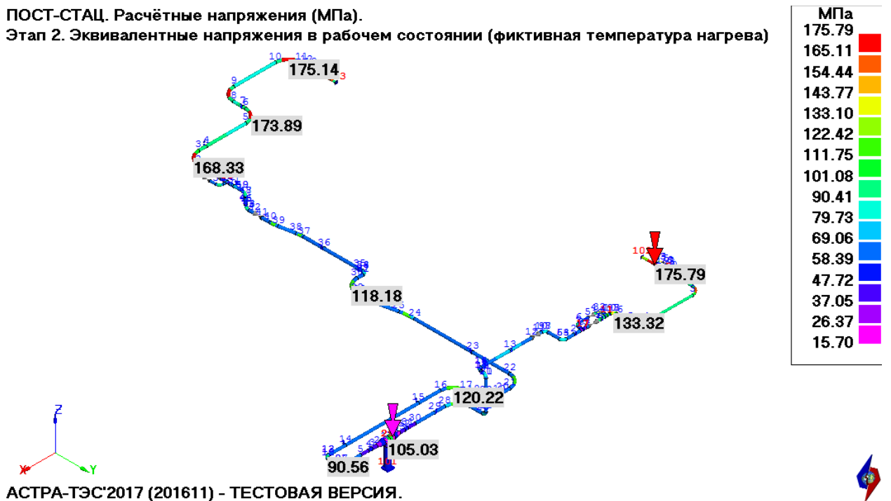
Рис. N4.4. Напряжения на этапе 2, МПа. Версия 201611
