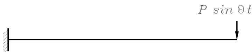
Рис. 5.1. Консоль, нагруженная периодической силой P .
