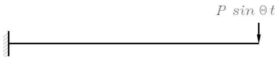
Рис. 4.1. Расчетная схема задачи: консольный стержень
