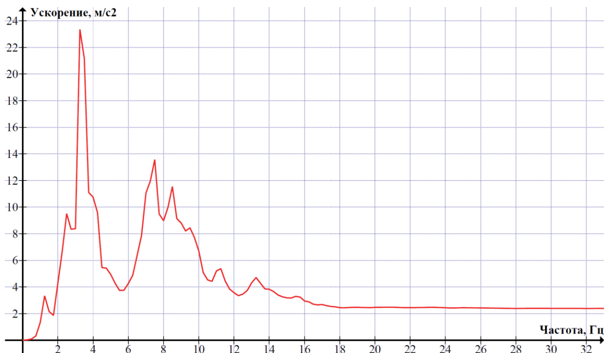
Рис. 0.6 Огибающий вертикальный спектр реакции для расчета светопрозрачной фасадной системы (для витража по оси «Д» м/о «2»/«10/1»)
