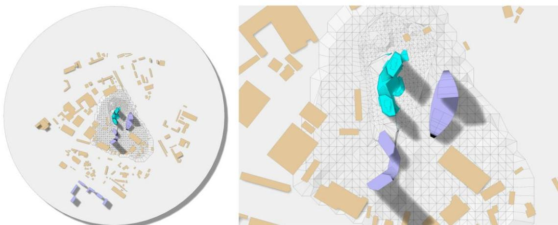
Рис. Геометрическая модель. Вид сверху. Оранжевым цветом выделена существующая застройка, зеленым – проектируемая застройка, фиолетовым – перспективная застройка.
