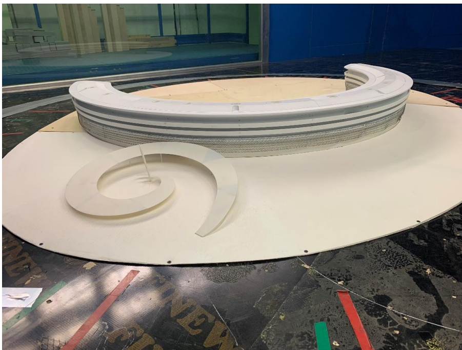
Рис. Модель исследуемого объекта в аэродинамической трубе
