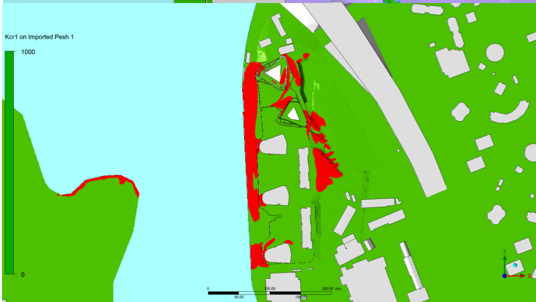
Рис. 1-й уровень пешеходной комфортности – превышение V_{cr1}=6 м/с не чаще K_{cr1}=1000 часов в год в пешеходной зоне
