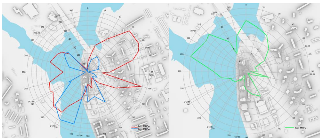
Рис. Опрокидывающие моменты ( M_x , M_y ) (а) и крутящий момент ( M_z ) (б), действующие на здание, МН*м. (значения приведены по модулю)
