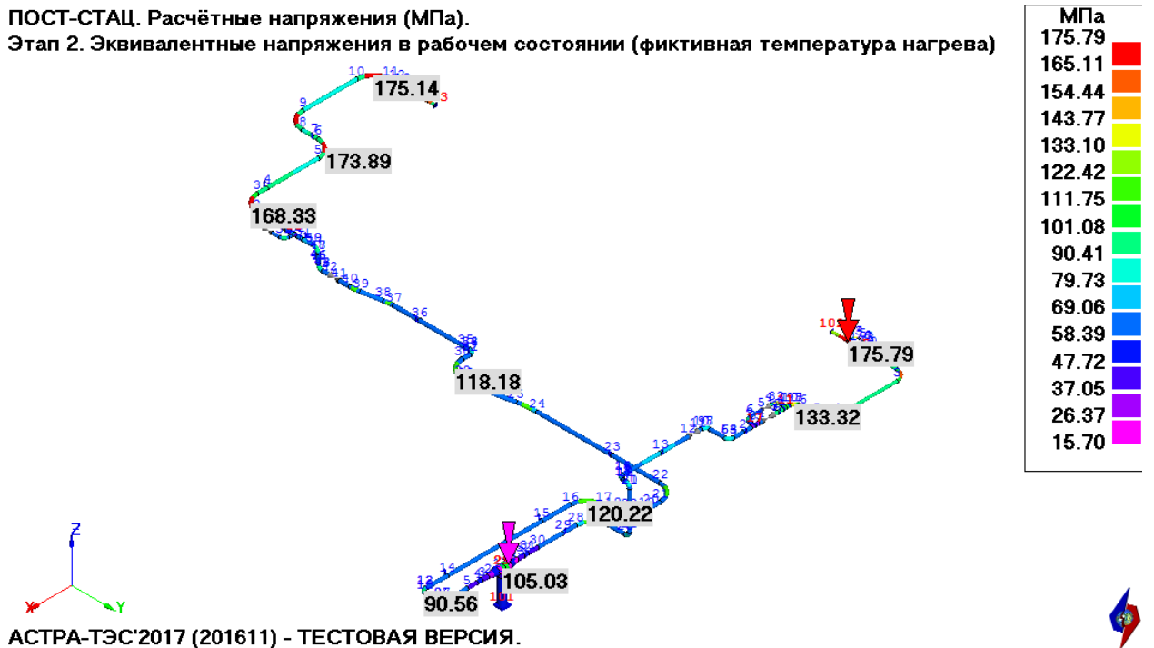
Рис. N4.4. Напряжения на этапе 2, МПа. Версия 201611
