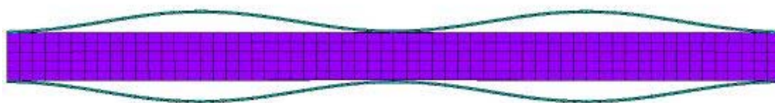
Рис. 2 – Форма потери устойчивости трехслойной балки в результате отслоения несущих слоев от наполнителя
